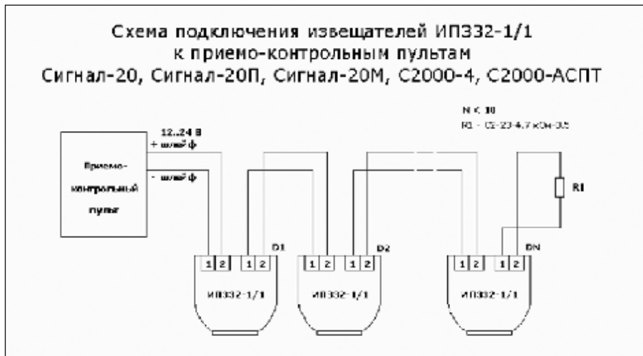
Рис. 2 Схема подключения к приемно-контрольным пультам системы «Орион» («НВП Болид», г. Королев, МО)
