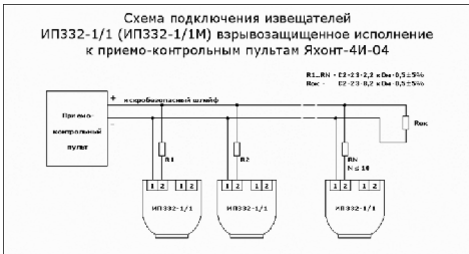
Рис. 3 Пример подключения извещателей во взрывозащищенном исполнении
