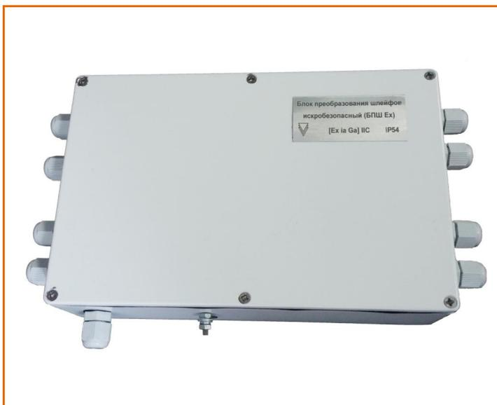
Блок обеспечивает гальваническое разделение искробезопасных цепей ШС и питания от искробезопасных ШС с помощью вторичного преобразователя DC-DC и оптоэлектронных реле. Электрическая прочность применяемых разделительных элементов – 5000 В
