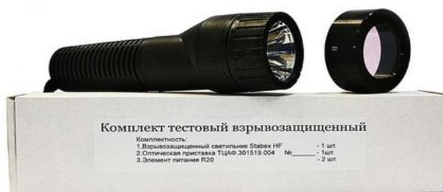
В комплект входят взрывозащищенный светильник Stabex HF производства фирмы “COOPER CROUSE HINDS GmbH” (Германия) и одна из оптических приставок производства АО “НИИ “Гириконд”:
