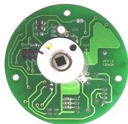
Преобразователь ИПП-3 имеет бескорпусное исполнение и устанавливается в корпус потребителя.
