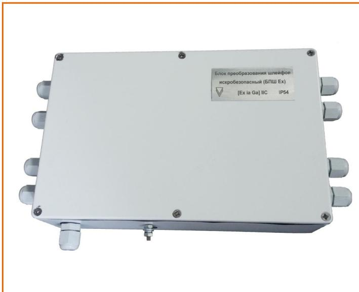
Блок обеспечивает гальваническое разделение искробезопасных ШС и цепей питания от искробезопасных ШС и цепей питания с помощью вторичного преобразователя DC-DC и оптоэлектронных реле. Электрическая прочность применяемых разделительных элементов – 5000 В
