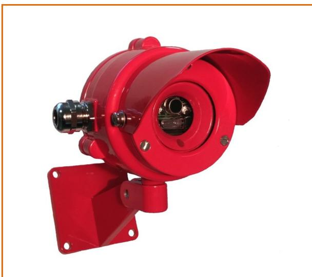
Благодаря использованию метода спектральной селекции в ИК канале и наличию дополнительного УФ канала извещатель сохраняет работоспособность и не теряет чувствительность при прямой солнечной засветке, засветках от искусственных источников освещения и при наличии в поле зрения нагретых объектов.
