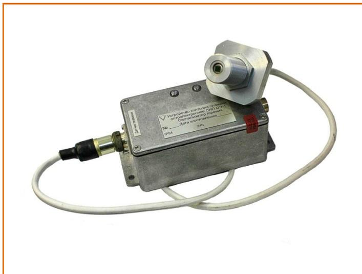
"П" ("прямой") - оптическая ось датчика пламени совпадает с его продольной геометрической осью
