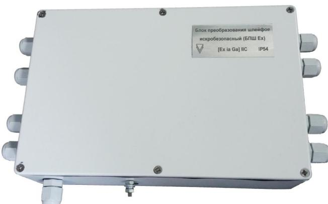
Блок обеспечивает гальваническое разделение искробезопасных ШС и цепей питания от искробезопасных ШС и цепей питания с помощью вторичного преобразователя DC-DC и оптоэлектронных реле. Электрическая прочность применяемых разделительных элементов – 5000 В
