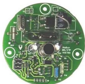
Преобразователь МПП-1 Б/К имеет бескорпусное исполнение и устанавливается в корпус потребителя.
