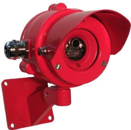
Благодаря использованию метода спектральной селекции в ИК канале и наличию дополнительного УФ канала извещатель сохраняет работоспособность и не теряет чувствительность при прямой солнечной засветке, засветках от искусственных источников освещения и при наличии в поле зрения нагретых объектов.
