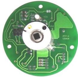
Преобразователь ИПП-3 имеет бескорпусное исполнение и устанавливается в корпус потребителя.
