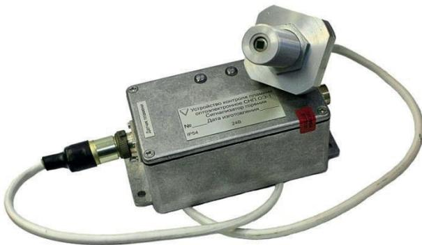
“П” (“прямой”) - оптическая ось датчика пламени совпадает с его продольной геометрической осью
